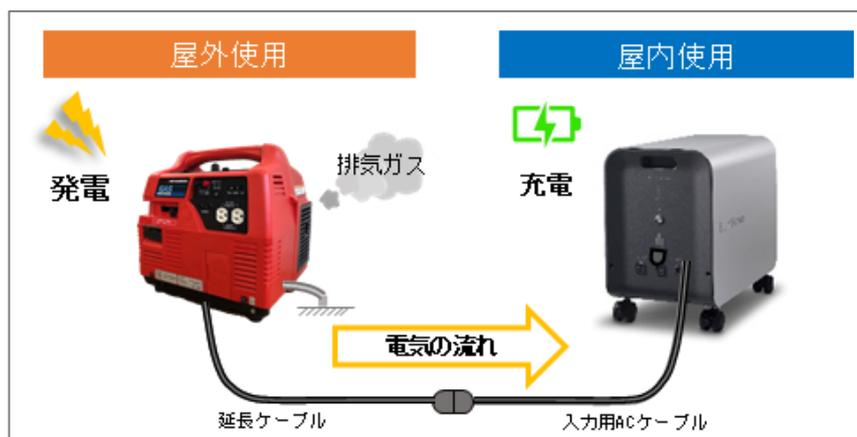
ポータブル発電機は、ガスボンベ2本で1時間の発電が可能であり、「POWER YIILE 3」（蓄電容量：2.5kWh）は、ガスボンベ6本（3回発電）で満充電されます。
